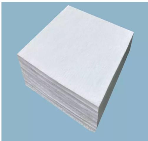
L'aerogel è mille volte meno denso del vetro, tre volte più pesante dell'aria, sopporta altissime temperature ed è un ottimo isolante termico. La bassissima conducibilità termica, la flessibilità, la resistenza alla compressione, l'idrofobicità, la traspirabilità e la facilità di utilizzo rendono **Nanofelt** l'isolamento tra i più isolanti in commercio, ad esclusione degli isolamenti sottovuoto.
