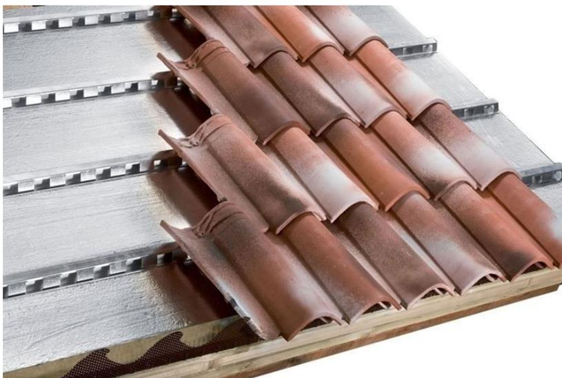
Posare struttura per copertura microventilata. Questa può essere eseguita con morali in legno o in metallo, solitamente posati ad interasse di 50/60 cm . Sotto ai morali posare il feltro nanotecnologico **NANOFELT** spessore 1 cm, per isolare il potenziale ponte termico.
