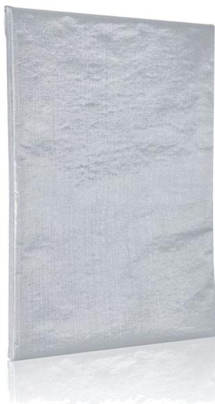
I pannelli vengono privati dell'aria al loro interno fino a ottenere bassissime pressioni: tale processo riduce fortemente la mobilità delle poche molecole d'aria rimaste, diminuendo la conducibilità termica, che raggiunge valori addirittura **inferiori** a 0,002 W/mK.
